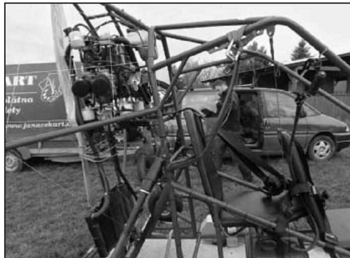
Detailní záběr na vítěznou tandemovou tříkolku Radka Johna, s tuningem motoru Rotax 582, výkon 65 koní. Je postavená na zakázku pro pořádné piloty, nosnost 300 kg.
