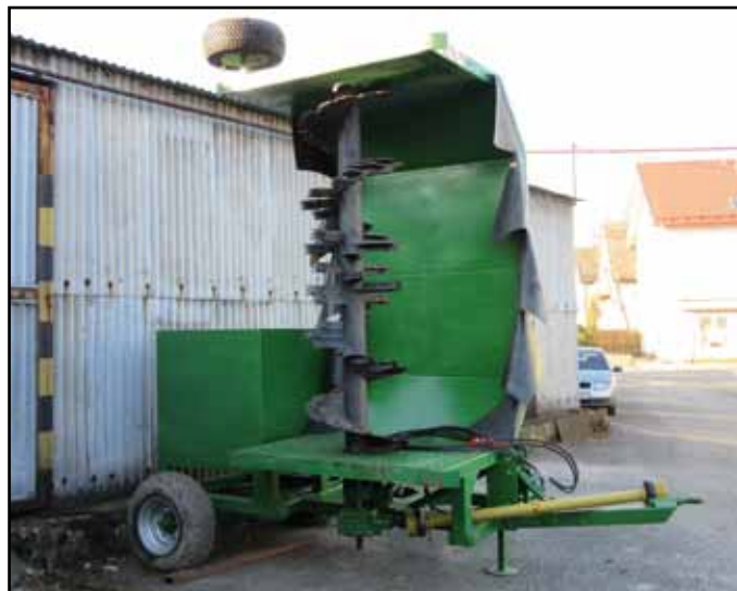
Překopávač drtí a provzdušňuje hmotu v kompostárně.
