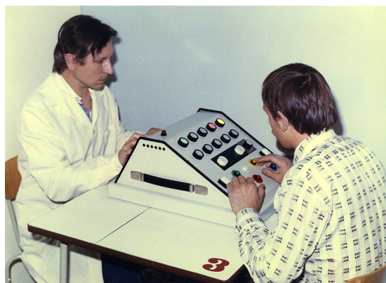
Vyšetřování reakcí řidiče na vizuální podněty Vídeňským determinačním přístrojem.
